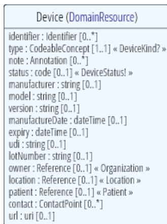
**Figura 9 - Diagramma UML della risorsa Device (hl7 2011)**
