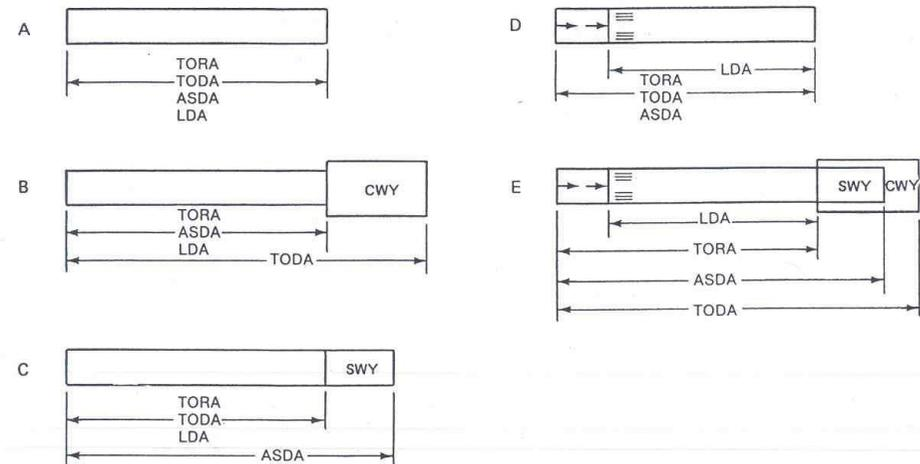
**TORA (Take-Off Run Available, corsa di decollo disponibile) lunghezza di pista dichiarata disponibile e adatta alla corsa a terra di un aereo che decolla;**
