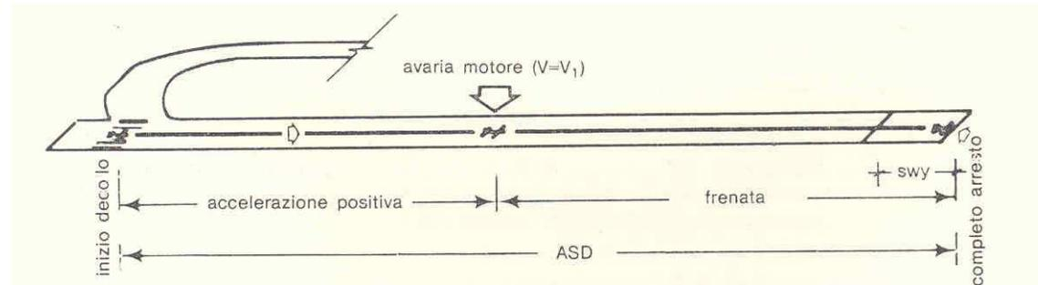
**ASD (Accelerate-Stop Distance) è la distanza compresa tra il punto di inizio decollo ed il punto di completo arresto del veivolo, nel caso di avaria al raggiungimento della velocità  $V_1$ .**
