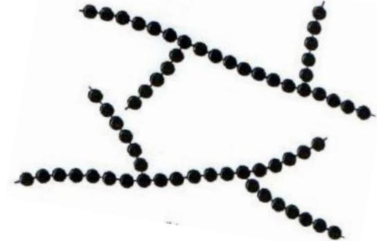
I polimeri possono essere sintetizzati in modo che dalla catena si dipartano **ramificazioni laterali**. Con la formazione delle ramificazioni si riducono le capacità di impacchettamento della catena, per cui **la densità del polimero diminuisce**. Gli stessi polimeri che formano strutture lineari possono anche essere polimeri ramificati.
