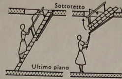
4 Se manca lo spazio per la scala al sottotetto e piccole soffitte, basta scala ribaltabile in legno o alluminio.
