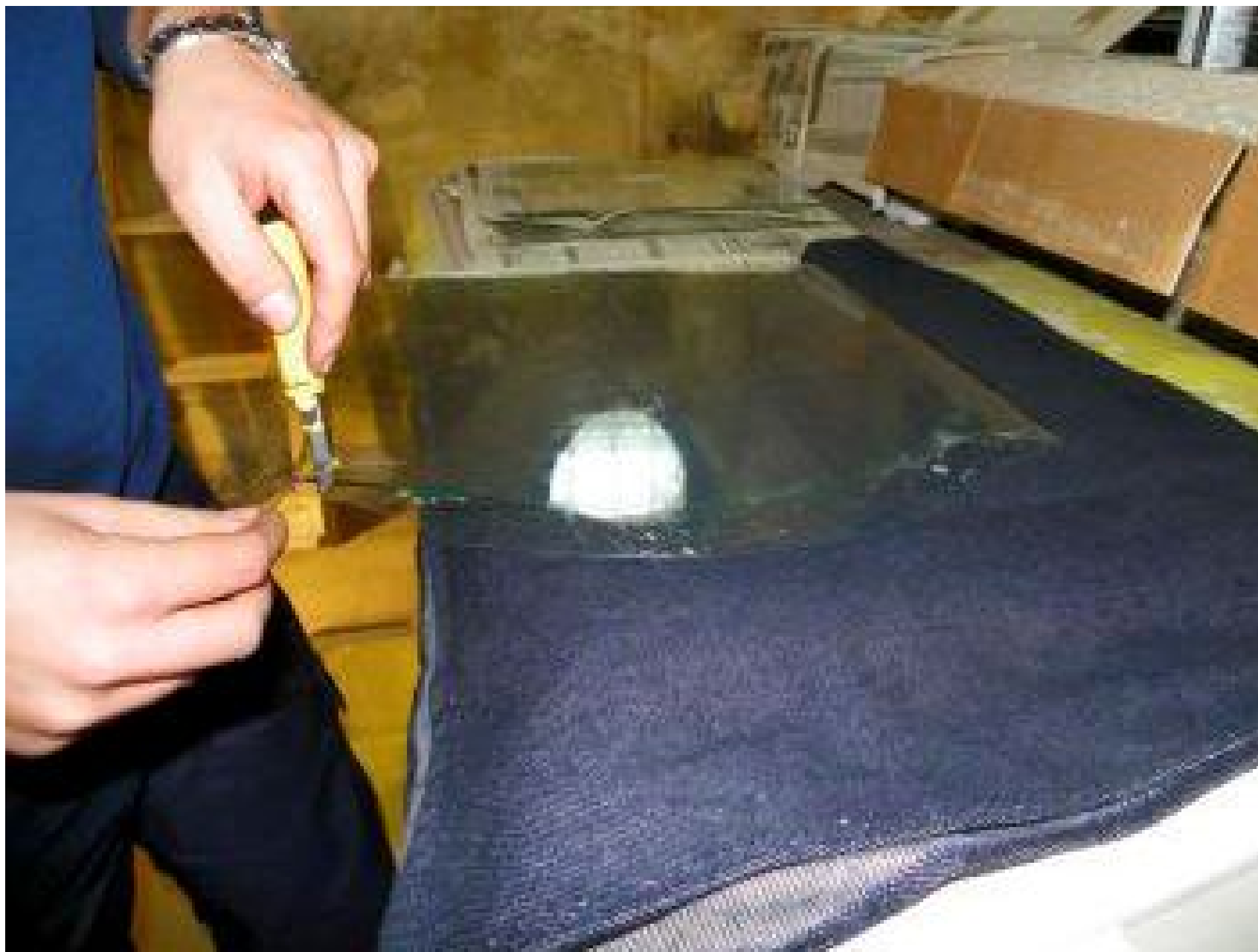
Figura 14 • Applicazione di pellicole di sicurezza
