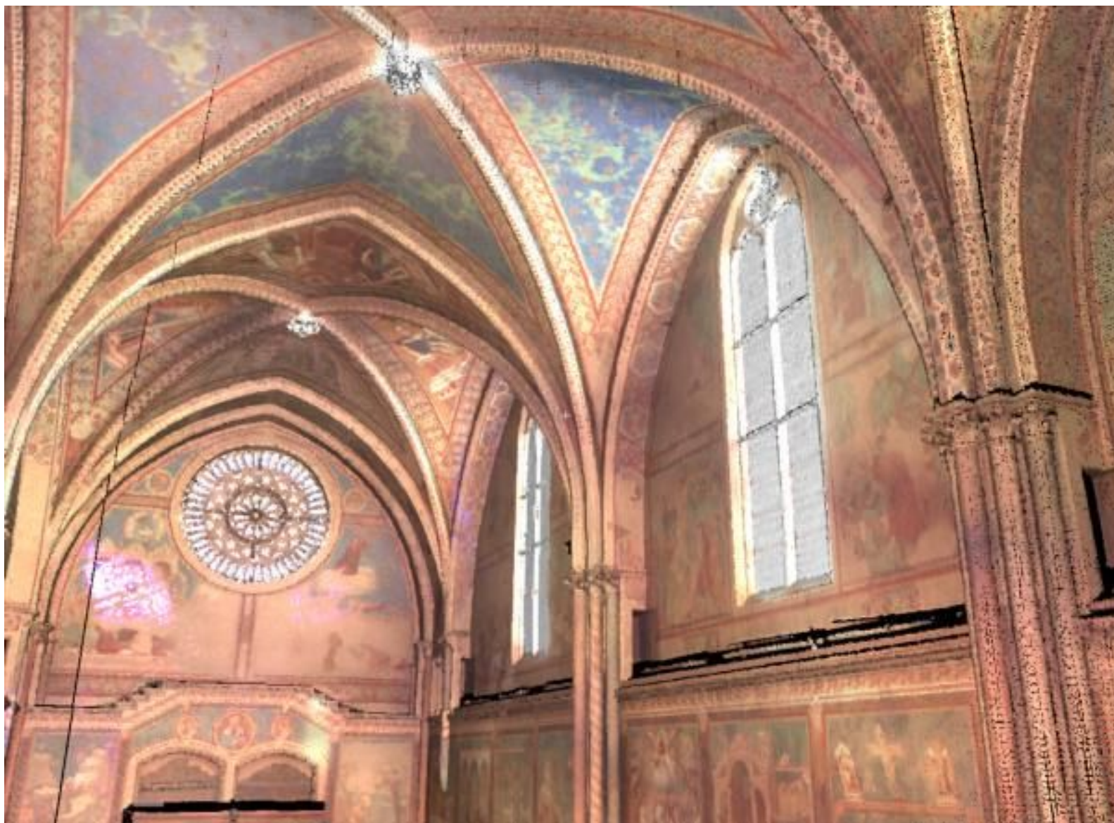
Figura 9 • Basilica Superiore di Assisi. Nuvola di punti dal laser scanner con dati RGB: elaborazioni sperimentali per il Ministero per i Beni e le attività culturali in occasione della ricostruzione virtuale della volta della Basilica, 2004. (SAT)
