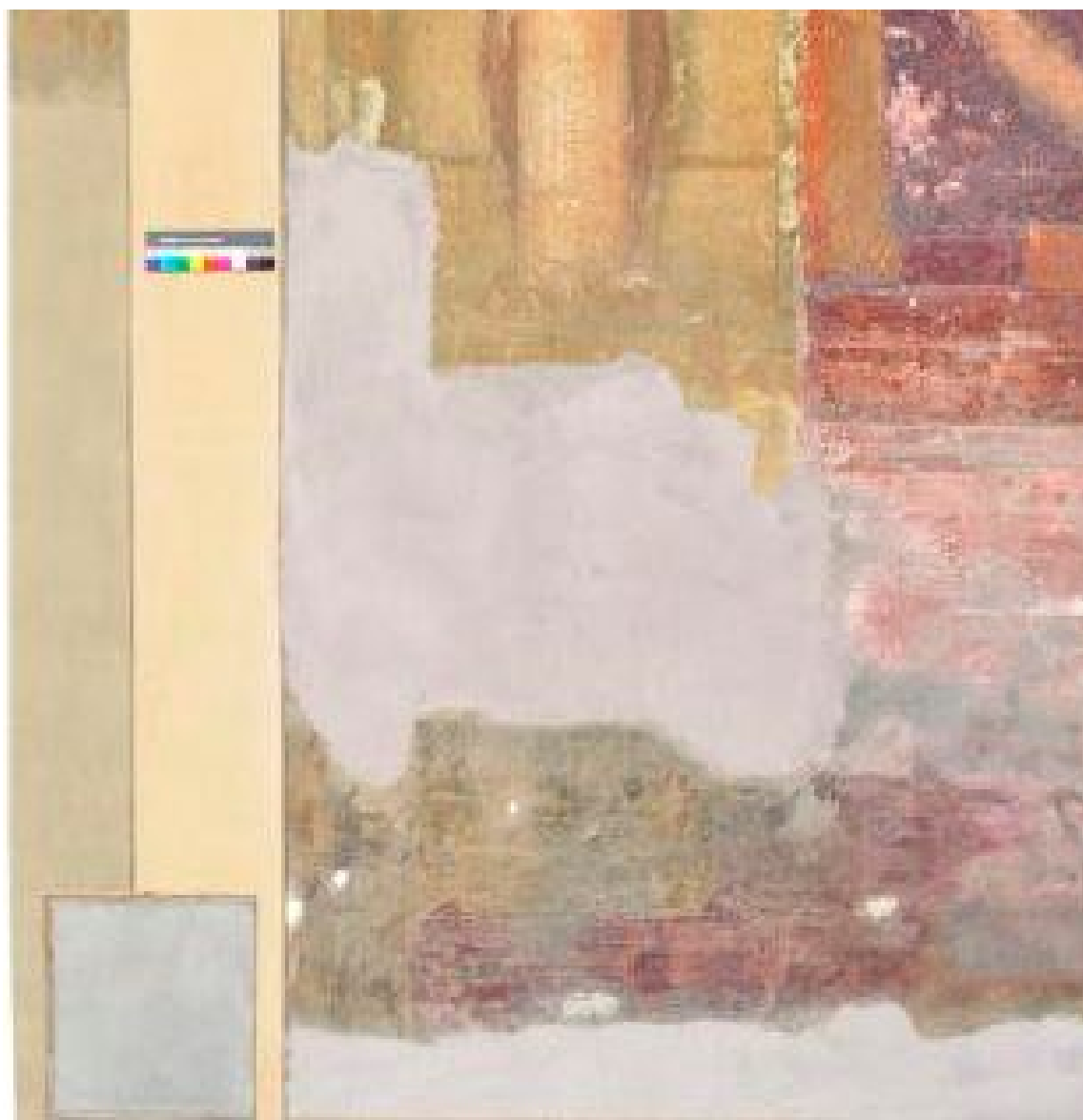
Figura 1c • Integrazione reale della lacuna effettuata con il medesimo intonaco del campione utilizzato nella simulazione. Come si può verificare confrontando le due immagini, la simulazione della integrazione è sufficientemente “realistica”. (MOGGIA)
