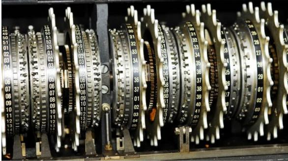
Figure 2: Un dettaglio degli ingranaggi di Colossus.
