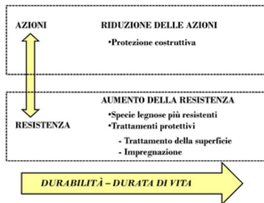
Fig. 3.1 - Strategie di progetto per aumentare la durabilità della costruzione
