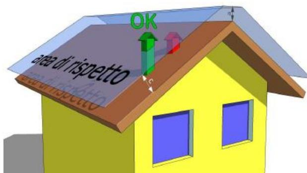
Fig. 4.37: Quote di sbocco sul tetto in pendenza
