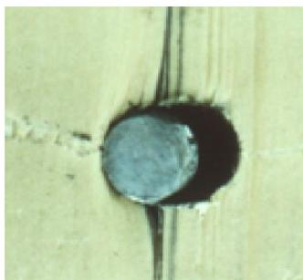
Fig. 6.28 – Nel caso di strutture lignee l'energia del terremoto è dissipata dagli elementi metallici di collegamento che, nel caso in cui presentino un comportamento duttile, si snervano e si plasticizzano prima che avvenga la rottura; viceversa il legno ha un comportamento fragile e si rompe senza una fase post-elastica.
