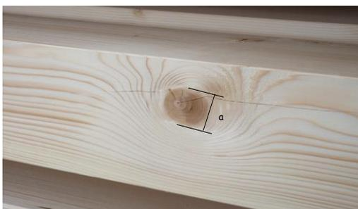
Fig. 6.7 - Nodo singolo sulla faccia
