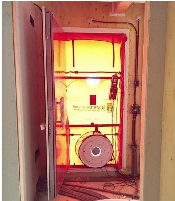
Fig. 4.76 - Attrezzatura per il Blower Door Test montata su una porta
