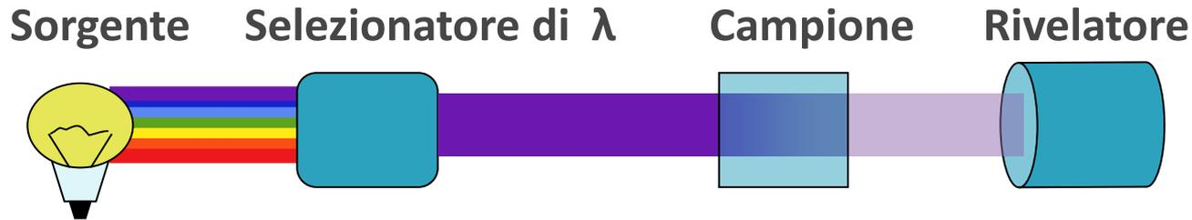
Schema a blocchi di uno spettrofotometro UV/vis
