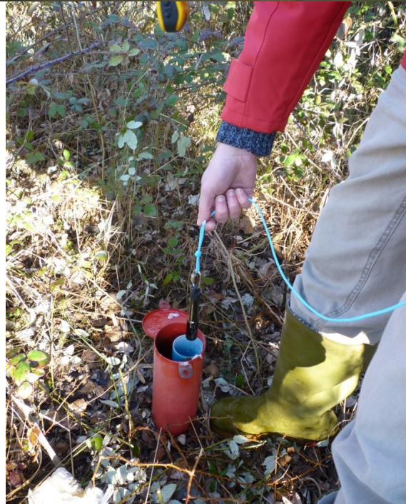
log di pozzo con sonda CTD
