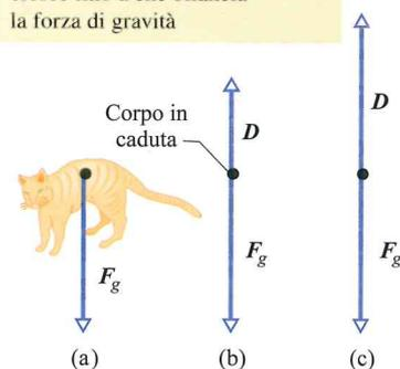
**Figura 6.6** Forze che agiscono su un corpo che cade nell'aria: (a) il corpo quando ha appena cominciato a cadere; (b) il diagramma vettoriale in un istante immediatamente successivo, non appena si è sviluppata la forza di resistenza aerodinamica. (c) La resistenza del mezzo è aumentata fino a controbilanciare la forza di gravità del corpo. Il corpo ora cade alla velocità limite costante.
