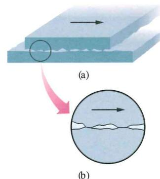
**Figura 6.2** Il meccanismo dell'attrito per sfregamento. (a) In questa immagine ingrandita la superficie superiore slitta verso destra sopra la superficie inferiore. (b) Un particolare, che mostra due punti di saldatura a freddo. È necessario applicare una forza per rompere questi punti di saldatura e mantenere il moto.
