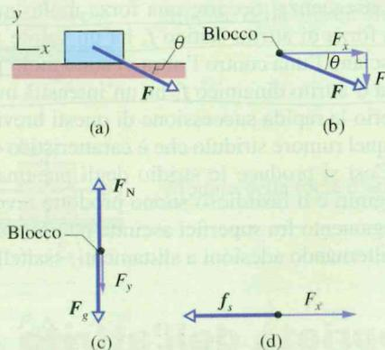
**Figura 6.3** Problema svolto 6.1. (a) Si applica una forza a un blocco inizialmente fermo. (b) Componenti della forza applicata. (c) Componenti verticali delle forze. (d) Componenti orizzontali delle forze.
