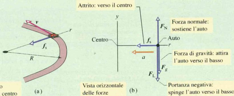
Figura 6.10 Problema svolto 6.5. (a) Un'automobile gira su un circuito circolare piano con velocità di modulo costante. La forza d'attrito  $f_s$  costituisce la necessaria forza centripeta lungo l'asse radiale  $r$ . (b) Diagramma delle forze (non in scala) per l'auto, viste in un piano verticale contenente  $r$ .
