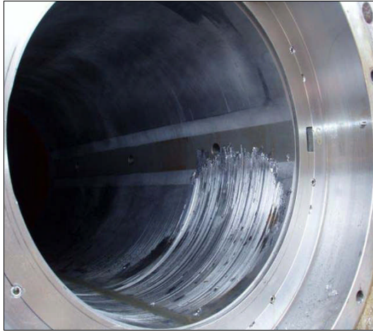
Fig. 0-13: Esempio di danneggiamento della boccola poppiera Errore. L'origine riferimento non è stata trovata.
