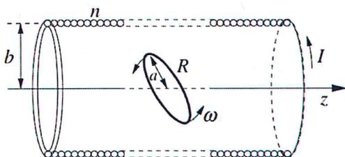
2. Una bobina composta da  $N=50$  spire di raggio  $a=3$  cm, con resistenza  $R=42$  m $\Omega$ , è immersa in un solenoide di raggio  $b=25$  cm con  $n=350$  m $^{-1}$  spire per unità di lunghezza, in cui scorre una corrente di  $I=3.2$  A come indicato in figura. La bobina viene fatta ruotare ad una frequenza costante di  $\nu=35$  Hz. Trascuriamo l'effetto della bobina sul solenoide.
