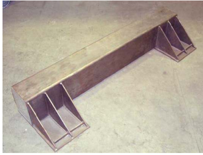
Fig. 41 Traversa con riempimento in schiuma metallica [Neu03], [MSZ06]
