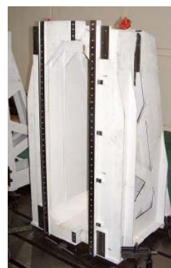
Fig. 43 Prototipo di montante realizzato con pannelli sandwich [Neu03]
