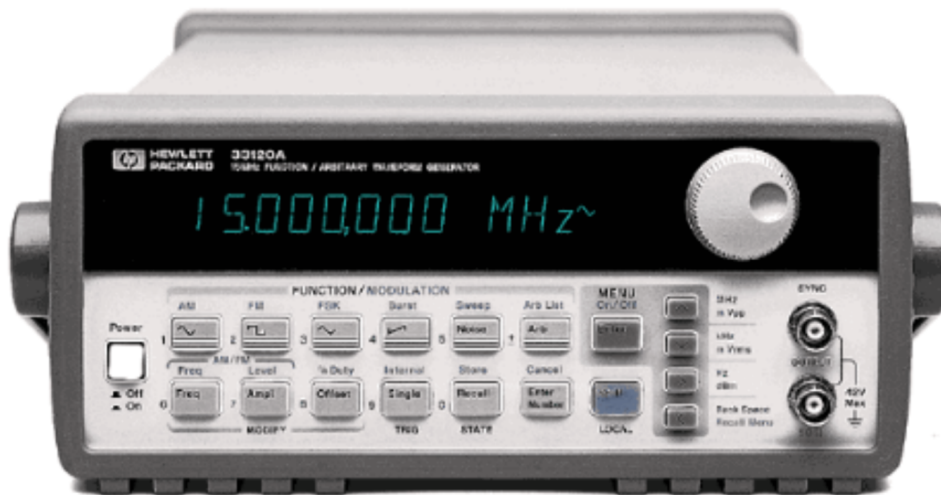
Figura 2.18: Un generatore di funzioni/segnali.
