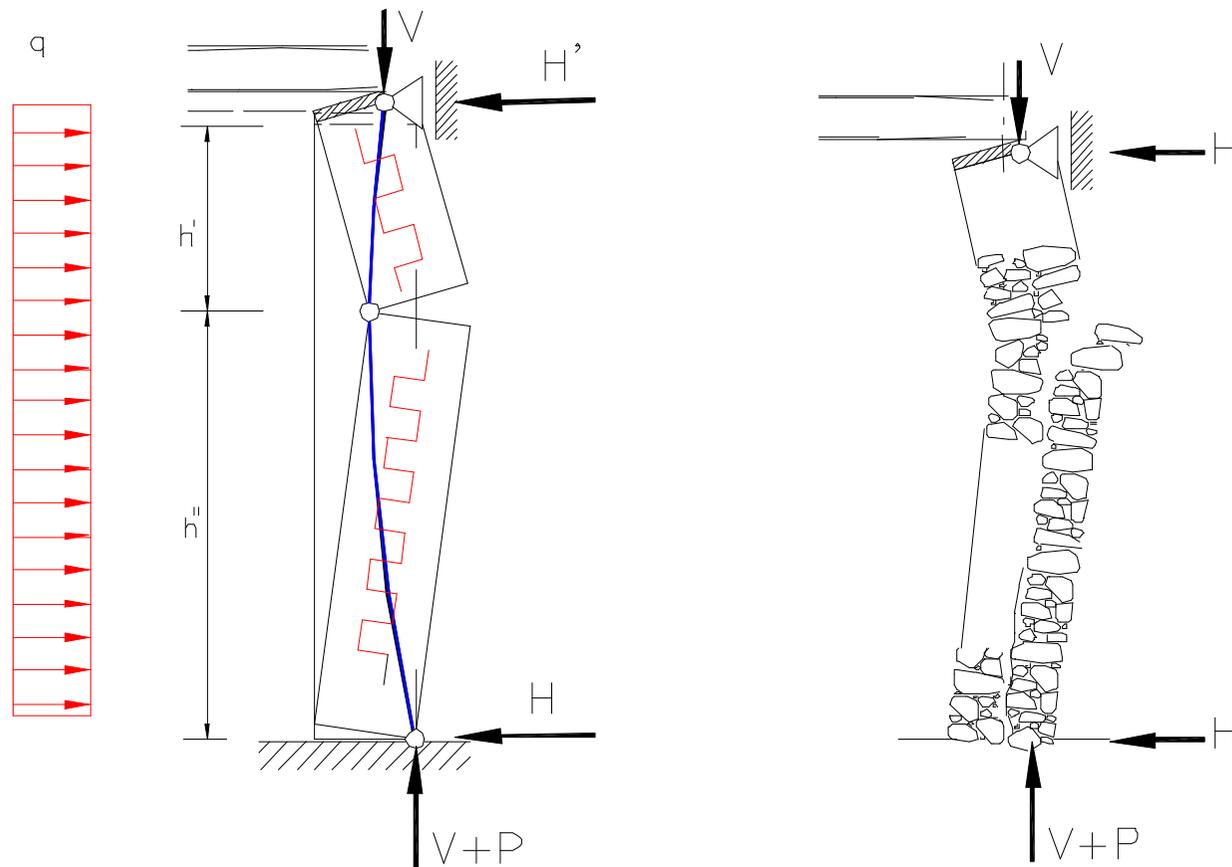
Se la muratura si disgrega, non si arriva alla formazione di meccanismi.
