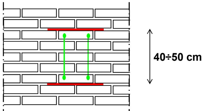
Per rilevare lo stato tensionale presente nella muratura si deve eseguire una lettura dei trasduttori prima di eseguire le sedi per alloggiare i martinetti.
