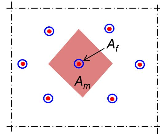
$f_c$  resistenza a compressione malta di iniezione,  $A_f$  area sezione foro,  $A_m$  area parete corrispondente ad ogni foro,  $\rho$  percentuale di armatura in ogni foro
