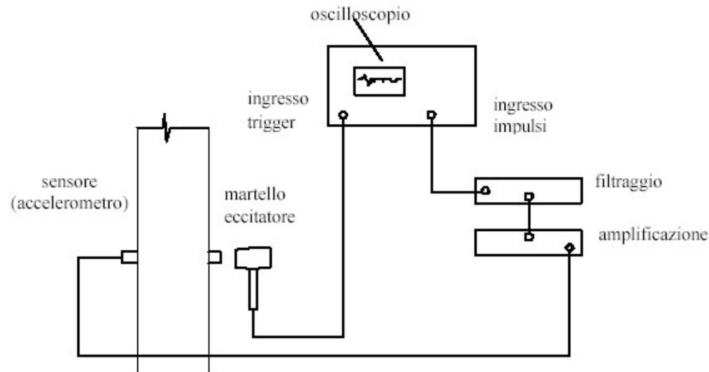
**Oscilloscopio analizza e registra le forme d'onda generate dal martello e rilevate dall'accelerometro situato sul lato opposto della muratura.**
