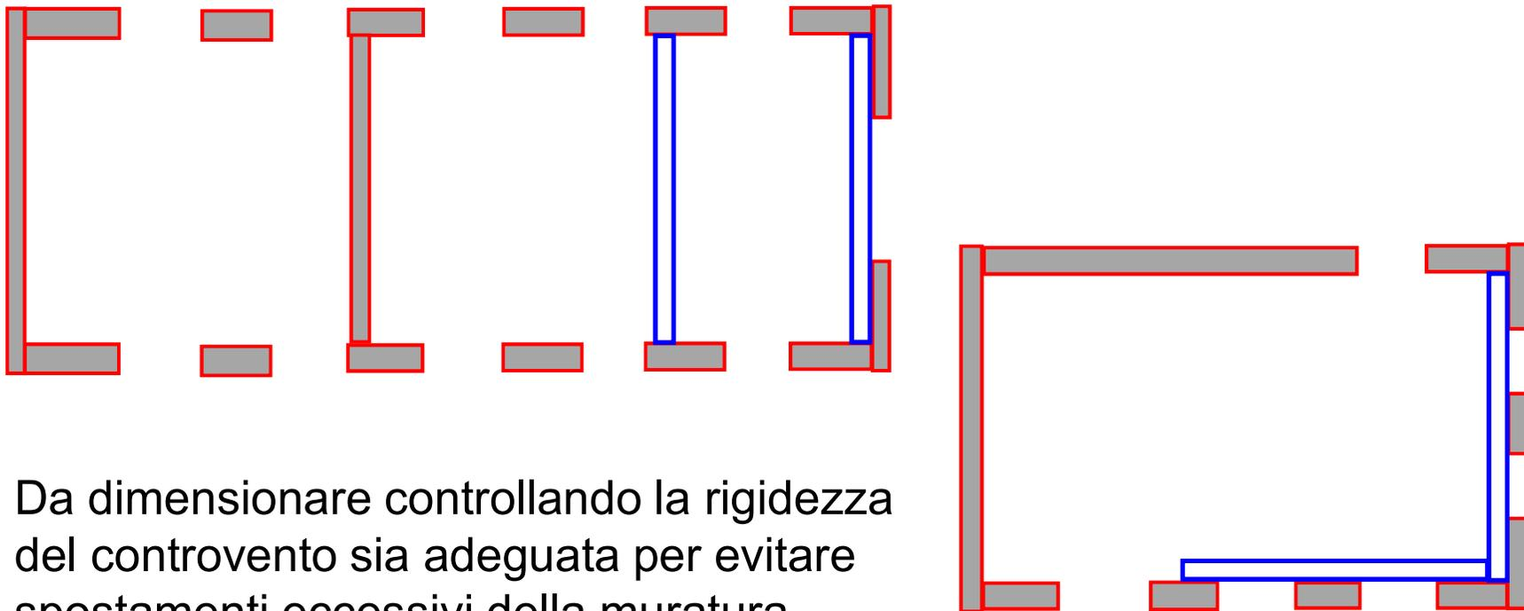
Da dimensionare controllando la rigidità del controvento sia adeguata per evitare spostamenti eccessivi della muratura.
