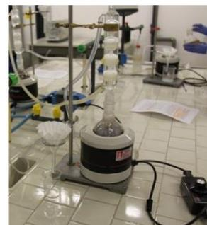
**ATTENZIONE:** i condensatori sono collegati in serie tra loro da tubi in plastica dentro i quali passa l'acqua del rubinetto. Fare molta attenzione per evitare l'allagamento dei tavoli con conseguente possibilità di scosse elettriche, danneggiamento dei quaderni e di qualsiasi cosa si trovi sui tavoli.
