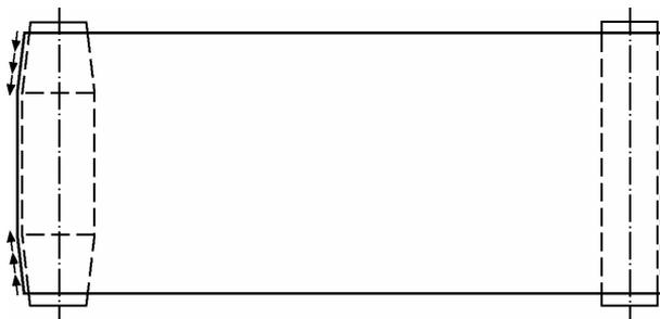
La forma cilindrico-conica viene normalmente utilizzata su almeno un tamburo, e nella maggior parte dei casi si tratta del tamburo motore. Il tamburo motore viene bloccato in posizione fissa mentre il rullo di rinvio viene installato in modo regolabile per consentire il centraggio del nastro. Utilizzando questo metodo, un nastro correttamente allineato può essere mantenuto in posizione centrale finché non intervengano elevate forze devianti.
