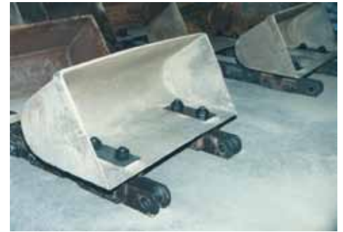
Catena smontabile con perni con testa Detachable chain with head pins Abnehmbare Kette mit Kopfbolzen
