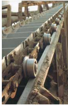
Trasportatore di clinker. Bucket apron conveyor for clinker. Becherzellband für Klinker.
