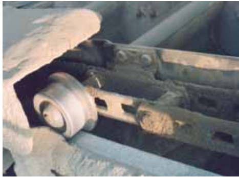
Trasportatore di clinker. Bucket apron conveyor for clinker. Becherzellband für Klinker.
