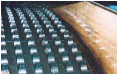
Ruota a 6 corone, 3" e 197 denti 3" and 197 teeth sixfold wheel Rad mit 6 Kronen, 3" und 197 Zähnen
