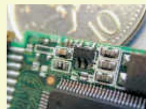
Il microprocessore è il cuore elaborativo del computer. È costituito da una sottile piastra di silicio su cui sono impressi milioni di componenti. Un microprocessore può contenere milioni di porte logiche.
