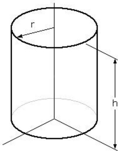
Schematizziamo la lattina come un cilindro di altezza  $h$  e raggio di base  $r$ . Il volume è dato da  $V = \pi r^2 h$  e l'area della lattina sarà data dalla somma dell'area di base e dell'area della superficie laterale.
