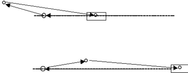
La figura aiuta a comprendere qual'è l'interpretazione fisica della configurazione di singolarità. Quando un meccanismo si trova in una configurazione di singolarità significa che perde la capacità di essere movimentato attraverso l'applicazione di una forza all'elemento motore. Basta osservare la figura soprastante. Se il pistone si trova nei cosiddetti punto morto inferiore o punto morto superiore, la forza applicata al pistone non fornirà alcun contributo alla rotazione.
