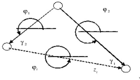
Se sono note solamente le velocità dei punti A e B si calcola la variazione rispetto al tempo del vettore che rappresenta il telaio fittizio
