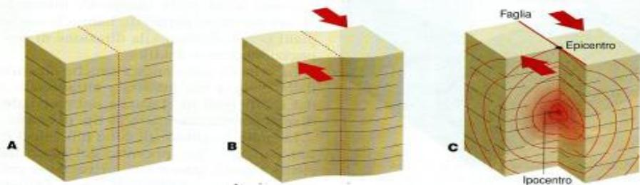
Figura 8.4. La figura illustra il comportamento di una massa di roccia sottoposta a forze di taglio secondo la teoria del rimbalzo elastico. (A), su un blocco crostale agiscono forze opposte.
