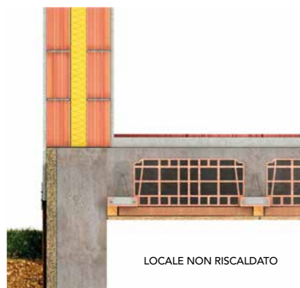
Fig. 18 Ponte termico parete controterra su locale non riscaldato. Correzione ordinaria (CO)
