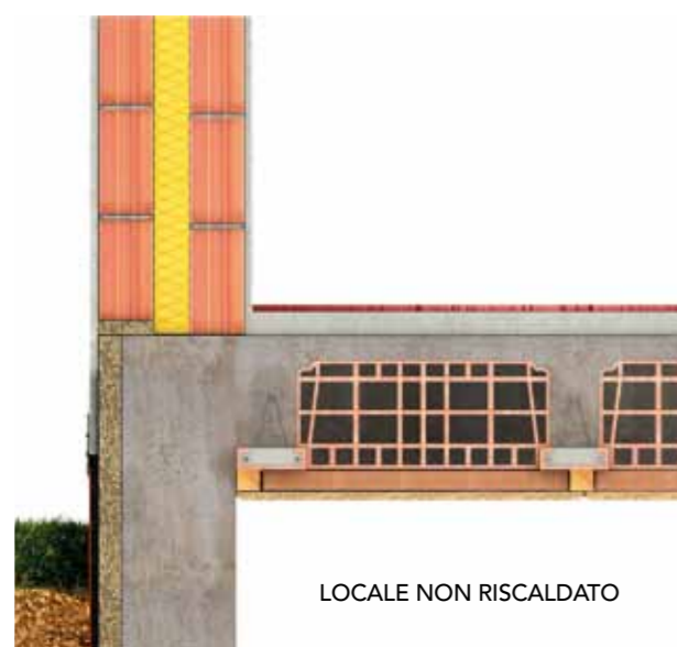
Fig. 19 Ponte termico parete controterra su locale non riscaldato. Correzione accurata (CA)
