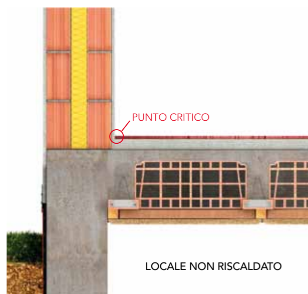
Fig. 17 Ponte termico parete controterra su locale non riscaldato. Non corretto
