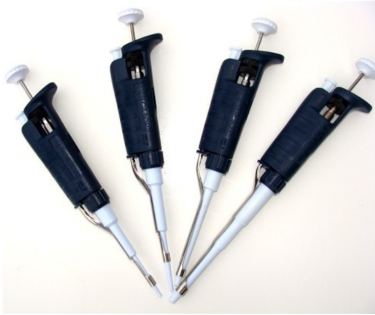
Micropipette a volume variabile (molto precise)
