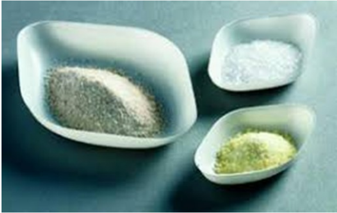
Navicella (NB necessario azzerare il peso) ( weighing tray )
