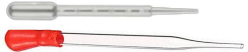
Pipetta Pasteur (poco precise)
