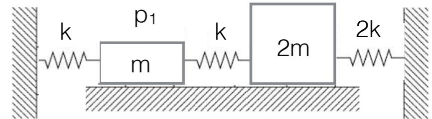
$$m \begin{bmatrix} 1 & 0 \\ 0 & 2 \end{bmatrix} \begin{Bmatrix} \ddot{x}_1 \\ \ddot{x}_2 \end{Bmatrix} + k \begin{bmatrix} 2 & -1 \\ -1 & 3 \end{bmatrix} \begin{Bmatrix} x_1 \\ x_2 \end{Bmatrix} = \begin{Bmatrix} p_o \\ 0 \end{Bmatrix} \cos \Omega t$$
