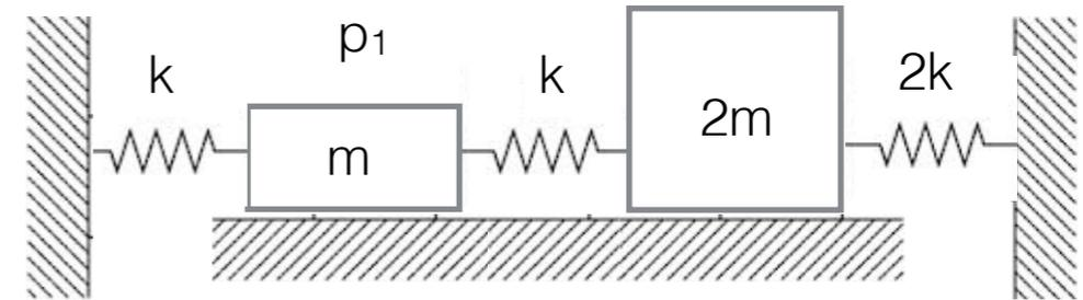
$$m \begin{bmatrix} 1 & 0 \\ 0 & 2 \end{bmatrix} \begin{Bmatrix} \ddot{x}_1 \\ \ddot{x}_2 \end{Bmatrix} + k \begin{bmatrix} 2 & -1 \\ -1 & 3 \end{bmatrix} \begin{Bmatrix} x_1 \\ x_2 \end{Bmatrix} = \begin{Bmatrix} p_0 \\ 0 \end{Bmatrix} \cos \Omega t$$
