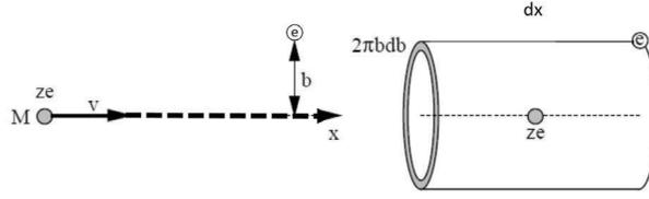
Figure 3: Interazione coulombiana tra particella carica incidente ed elettroni atomici appartenenti a un guscio cilindrico di raggio  $b$ , spessore  $db$  e altezza  $dx$
