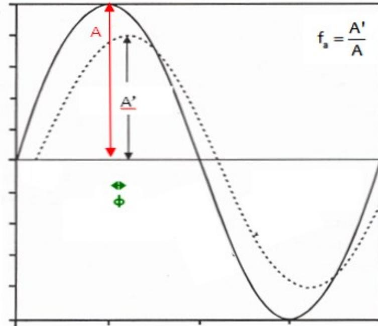
Rappresentazione dell'attenuazione e dello sfasamento dell'onda termica. La curva continua rappresenta l'andamento della temperatura superficiale nel tempo, quella tratteggiata l'andamento della temperatura in un punto interno della parete
