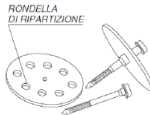
VITE adatta al fissaggio dell'isolante su orditi di metallo o legno
