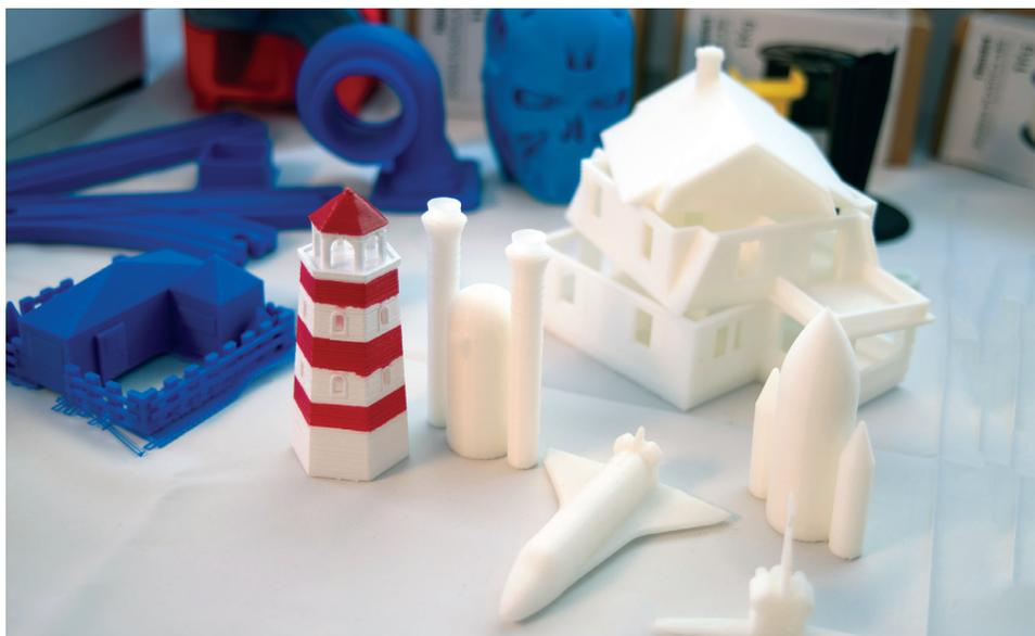
**Figura 1.2** – Carrellata di prodotti che si possono realizzare in maniera additiva (strato su strato) con le stampanti 3D che usano un estrusore per scaldare un filamento di ABS o PLA e depositarlo strato per strato fino a formare il prodotto finito.
