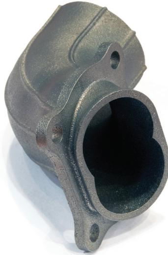
**Figura 1.5** – Un collettore per uso automobilistico stampato in 3D fondendo polveri di metallo con la tecnologia di fusione mediante raggio laser. Le sue caratteristiche fisiche e meccaniche sono equivalenti a un prodotto realizzato con le tecnologie tradizionali di fabbricazione.
