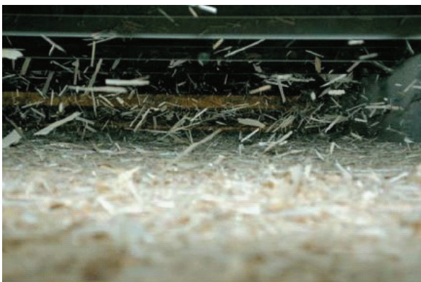
Distribuzione dei trucioli dello strato centrale
