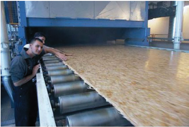
Pannello „ininterrotto“ sui rulli della pressa
