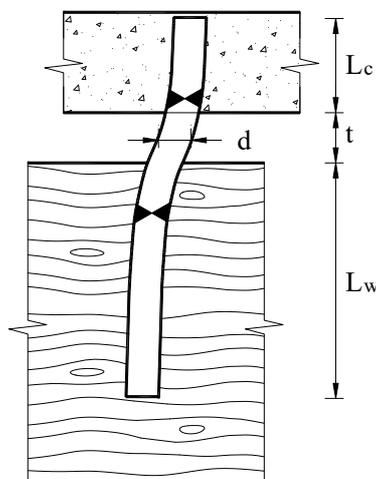
Figura 8-27- Connessione realizzata con spinotti a gambo cilindrico
