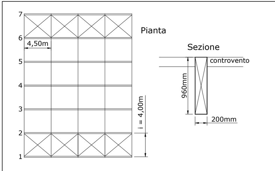
Figura 17-3 – Schema della struttura di copertura
