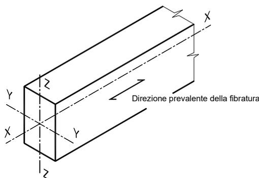
Figura 7-3 – Assi del sistema di riferimento dell'elemento strutturale
