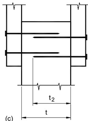
Figura 8-15– Possibilità di sovrapposizione per chiodi infissi senza preforatura
