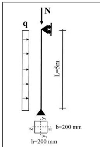
Figura 17-7 – Schema statico della colonna
