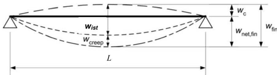
Figura 7-2 – Aliquote della deformazione di una trave inflessa
