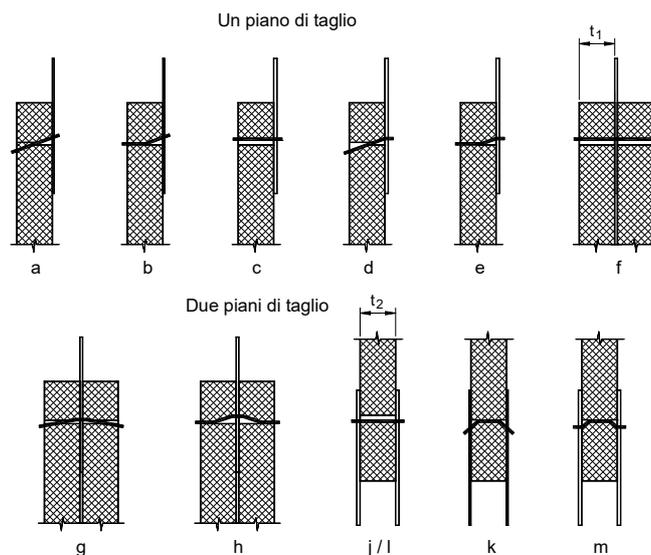
Figura 8-13- Modi di rottura per unioni acciaio-legno
