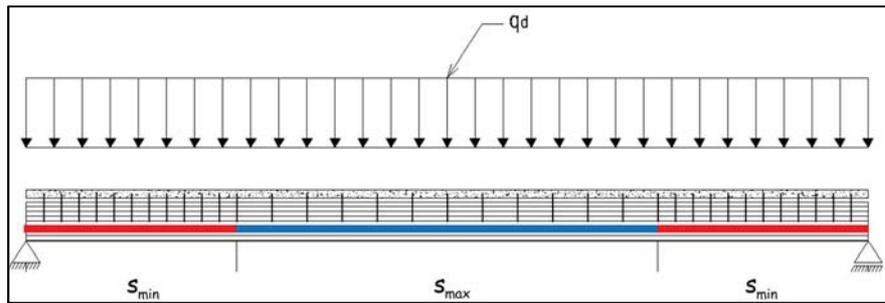
Figura 17-9 - Disposizione dei connettori all'interno della trave
