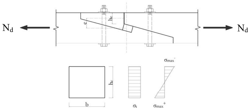
Figura 8-7 – Verifica a tensoflessione della porzione superiore
