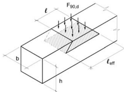
compressione ortogonale alla fibratura (effetto di confinamento), la lunghezza efficace di appoggio  $l_{ef}$  può essere convenientemente aumentata rispetto alla lunghezza reale  $l$  secondo quanto di seguito indicato (con  $l$  espressa in mm):
