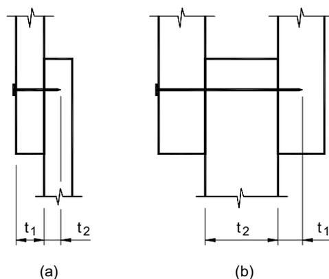
Figura 8-14– Definizione degli spessori  $t_1$  e  $t_2$
