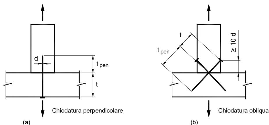
Figura 8-18 – Disposizione della chiodatura perpendicolare ed obliqua
