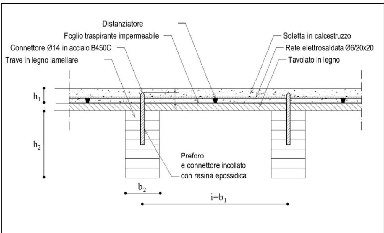
Figura 17-8 - Sezione-tipo del solaio misto legno-calcestruzzo
