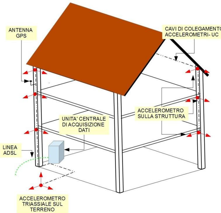
Un sistema per il monitoraggio sismico «completo» di un edificio è costituito da un accelerometro triassiale sul terreno e da N accelerometri fissati alla struttura al livello dei vari impalcati.
