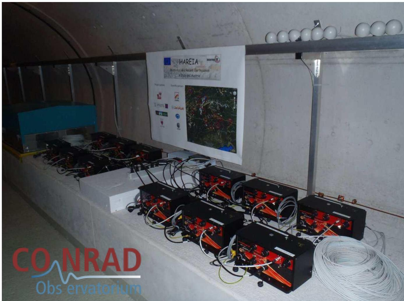
I 12 accelerometri, prima dell'installazione definitiva sul campo, installati sul plinto della galleria del Conrad Observatory per la prova di rumore strumentale.
