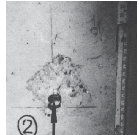
Fig. 6.17: a) curve tipiche di spostamento del carico in presenza di sollecitazione assiale e a taglio [Bibliografia 68]; b) rottura di un tassello posizionato lontano dal bordo in seguito a sollecitazione a taglio [Bibliografia 33].
