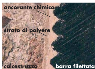
Fig. 6.32: pulizia del foro male effettuata in un'ancorante ad iniezione [Bibliografia 56]
