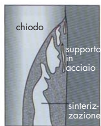
chiodo sparato in un supporto di acciaio (comportamento schematico) fusione dell'acciaio in prossimità della punta
