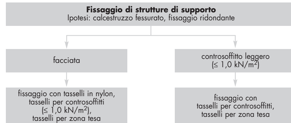
Fig. 10.6: tasselli per strutture di supporto
