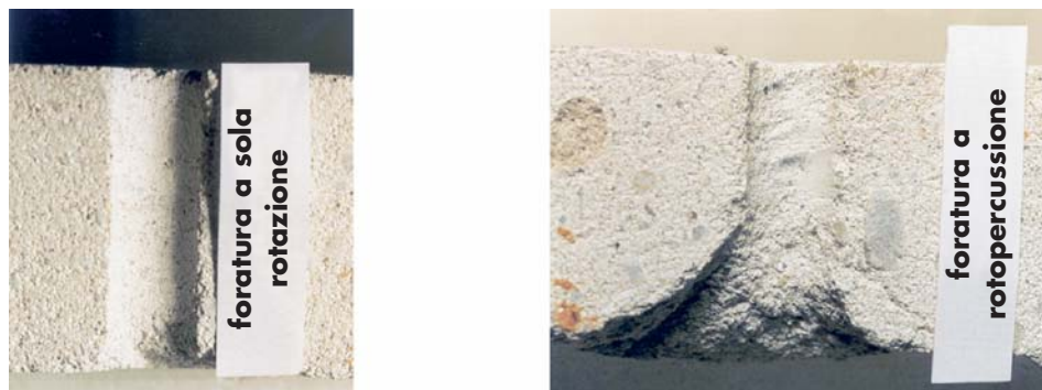
Fig. 6.43: influenza della modalità di foratura sulla geometria del foro in elementi forati in arenaria calcarea (a sinistra foratura a rotazione, a destra foratura a rotopercussione)
