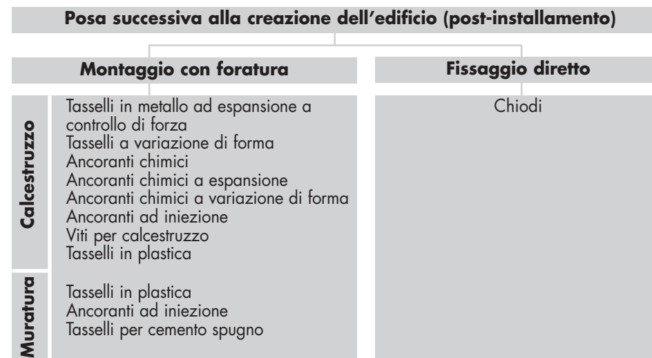
Fig. 2.3: sistemi di fissaggio su strutture preesistenti
