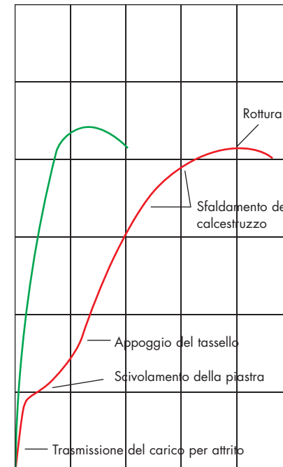
Fig. 6.17: a) curve tipiche di spostamento del carico in presenza di sollecitazione assiale e a taglio [Bibliografia 68]; b) rottura di un tassello posizionato lontano dal bordo in seguito a sollecitazione a taglio [Bibliografia 33].
