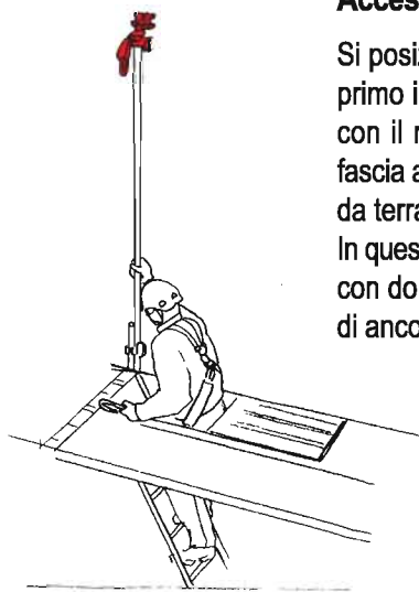
Accesso al primo impalcato
