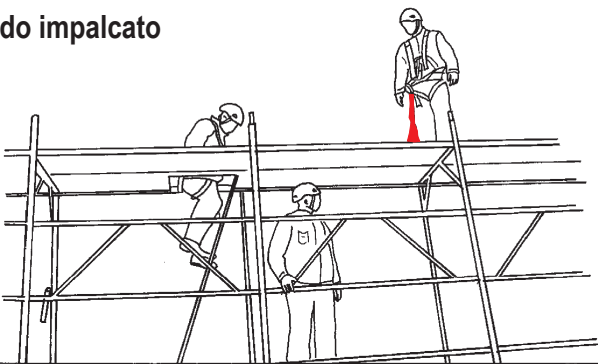
Accesso al secondo impalcato
