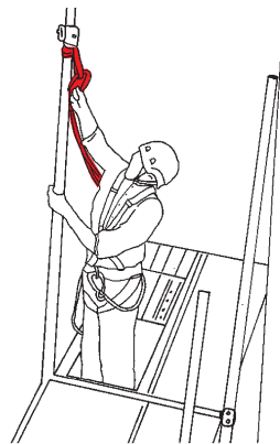
Accesso al primo impalcato
