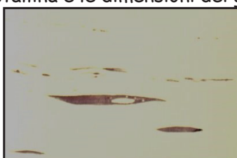
Stringler longitudinali di inclusioni (esame macroscopico).
