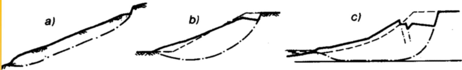
Fig. 2.2. Scivolamenti: a) di traslazione; b) di rotazione; c) composti
