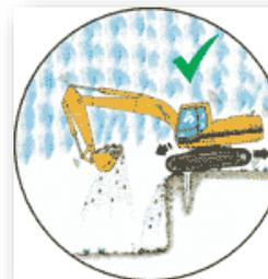
Qualora si disponga il cingolo del mezzo meccanico parallelamente alla scarpata dello scavo, in caso di franamento improvviso della parete, il mezzo si rovescerà finendo nel fondo della scarpata, con gravi danni e conseguenze per l'operatore.
