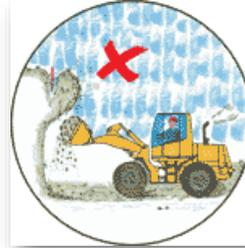
Adottare particolari precauzioni qualora si lavori in prossimità di fossati, trincee e scarpate. Un movimento sbagliato può far cadere il mezzo meccanico nel fondo dello scavo.
