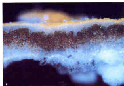
Tav. 2. Sezioni di talli di Caloplaca flavescens osservate al microscopio a fluorescenza. Tallo non trattato (1), talli osservati un mese dopo il trattamento con Lichenicida 264 (2), clorotene (3), Algoplase (4), Neo-Desogen (5) e Metatin N58-10/101 (6).
