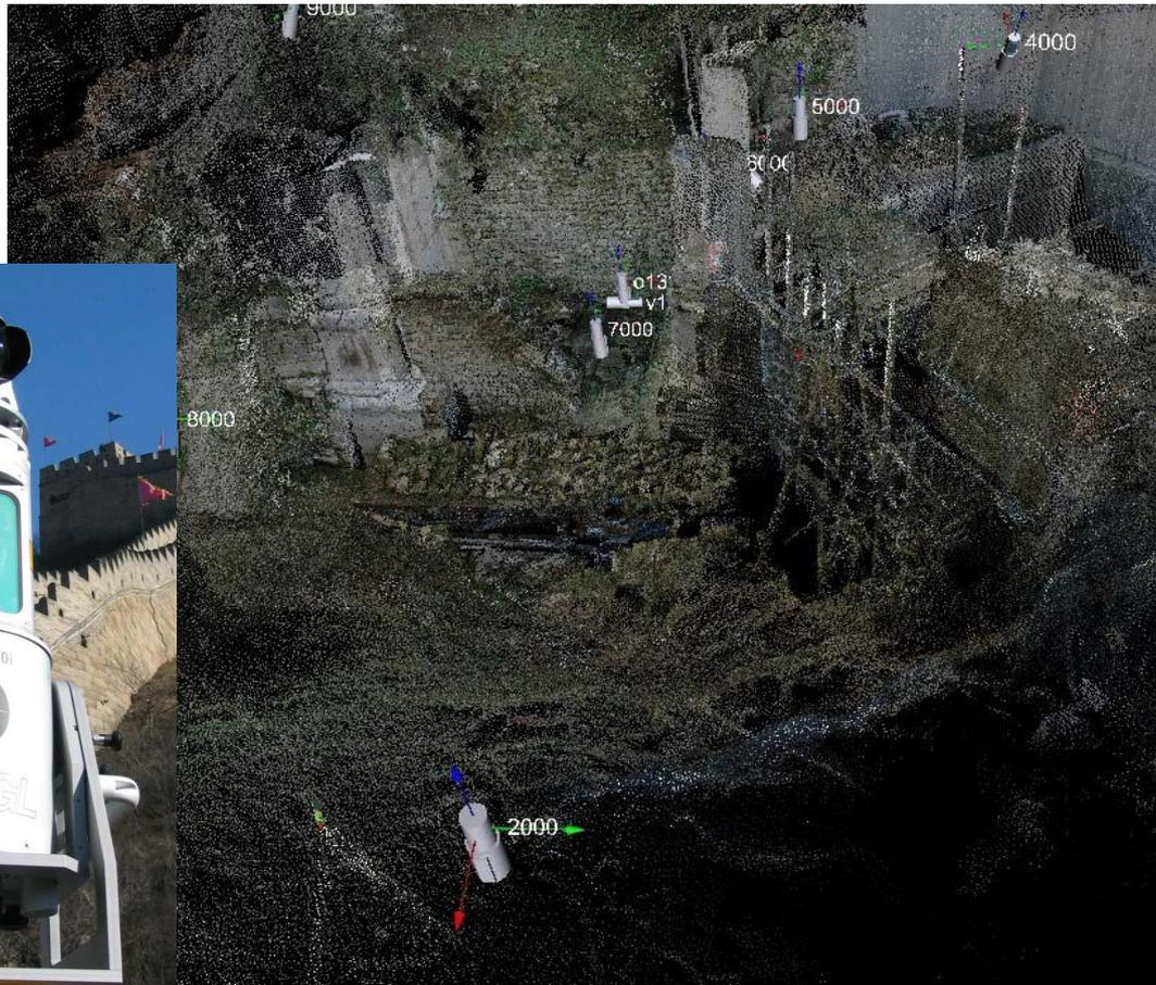
Impostato un passo di campionamento ed il campo di misura il laser scanner rileva qualsiasi oggetto che sia in vista e alla portata dello strumento.
