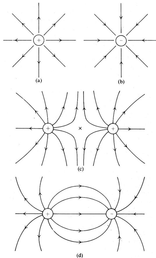
Linee di campo sono piu' fitte dove il campo elettrico e' piu' intenso. Nel punto medio tra due cariche dello stesso segno il campo e' nullo.
