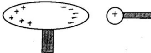
La carica totale nel conduttore e' zero, ma elettroni si sono spostati per induzione nella parte vicino corpo carico lasciando deficienza di elettroni nell'altra parte
