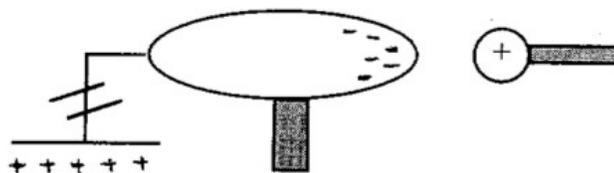
Tagliamo connessione con la terra. Se ora allontaniamo corpo carico il conduttore conserva eccesso di carica negativa → elettrizzato
