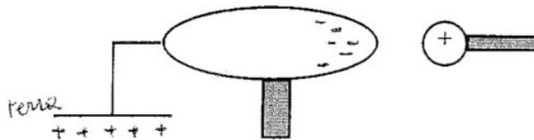
Conduttore collegato a terra → elettroni fluiscono da terra per neutralizzare parte positiva lontana da corpo carico (terra perde elettroni, ma la terra e' un serbatoio talmente grande di elettroni da potersi considerare infinito rispetto alle nostre applicazioni).
