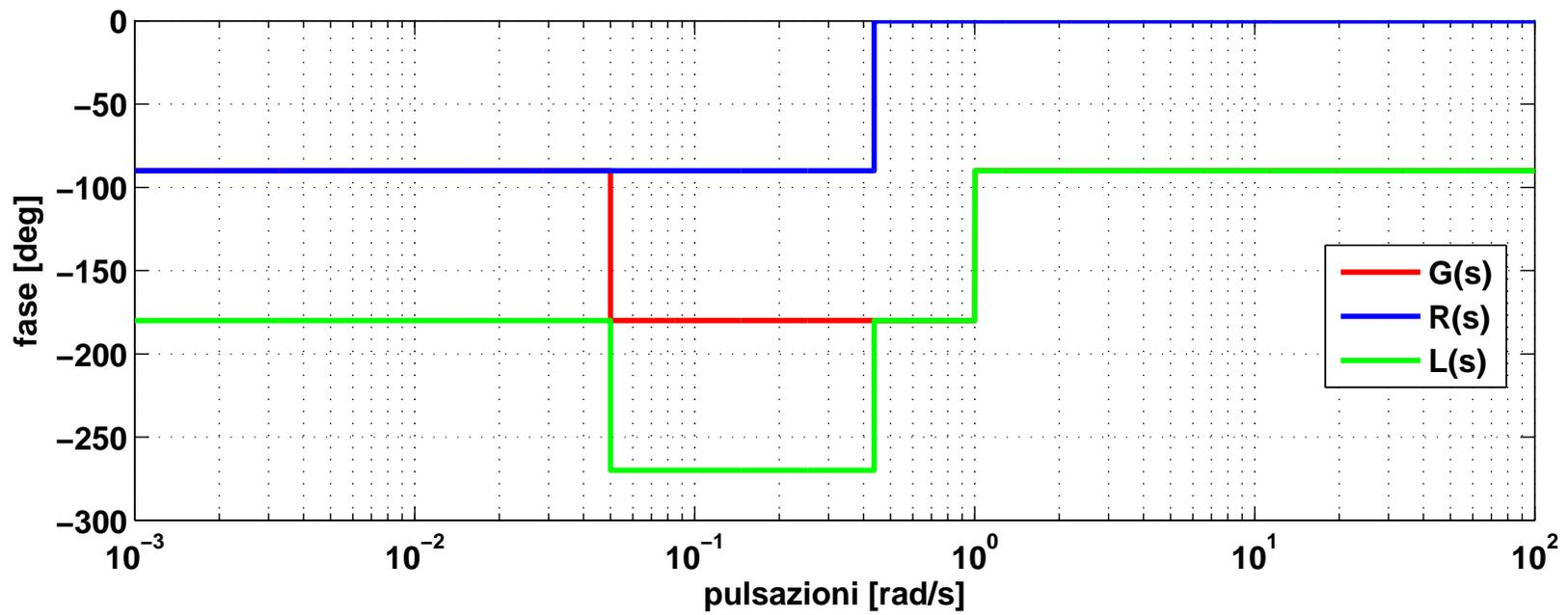
Figura 4: Diagrammi di Bode asintotici della risposta in frequenza: primo progetto.
