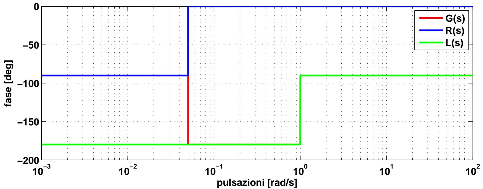
Figura 5: Diagrammi di Bode asintotici della risposta in frequenza: secondo progetto.
