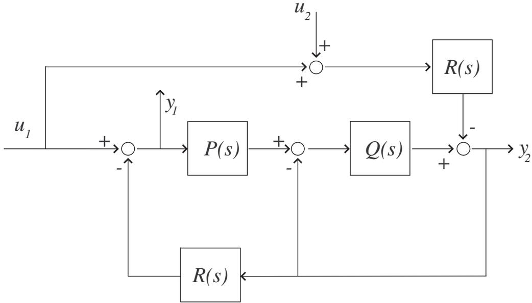
**Domanda 2.1** Si determini la funzione di trasferimento fra l'ingresso  $u_1$  e l'uscita  $y_2$  in funzione di  $P(s)$ ,  $Q(s)$ ,  $R(s)$ .
