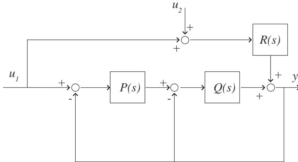
**Domanda 2.1** Si determini la funzione di trasferimento fra l'ingresso  $u_1$  e l'uscita  $y$  in funzione di  $P(s)$ ,  $Q(s)$ ,  $R(s)$ .
