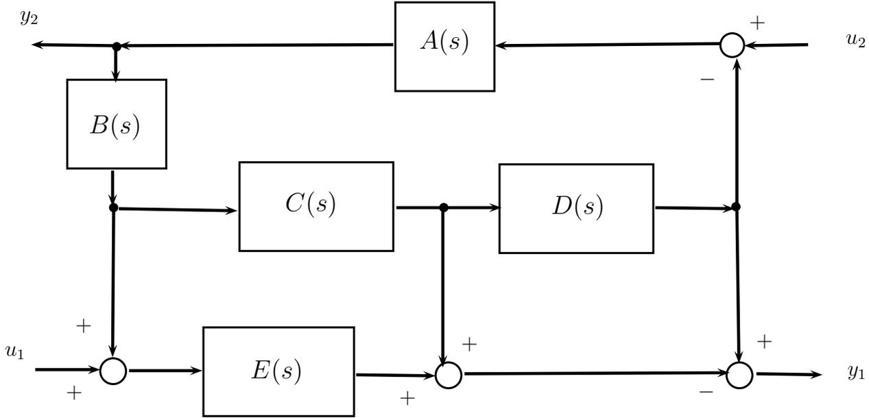
dove le funzioni di trasferimento elementari  $A(s)$ ,  $B(s)$ ,  $C(s)$ ,  $D(s)$  sono generiche funzioni di trasferimento che descrivono sistemi dinamici lineari a tempo continuo.
