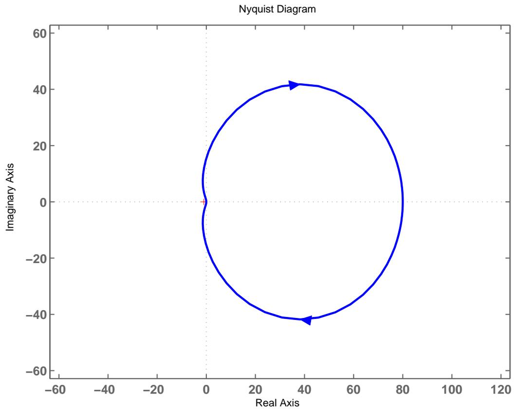
Figura 2: **Diagramma di Nyquist della Fdt  $L(s)$ .**
