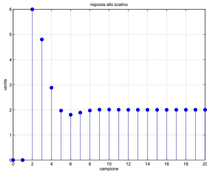
Figura 1: Risposta allo scalino unitario di un sistema dinamico LTI a tempo discreto.
