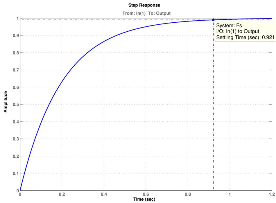
Figura 7: Risposta allo scalino per il sistema a ciclo chiuso nel caso del terzo progetto.
