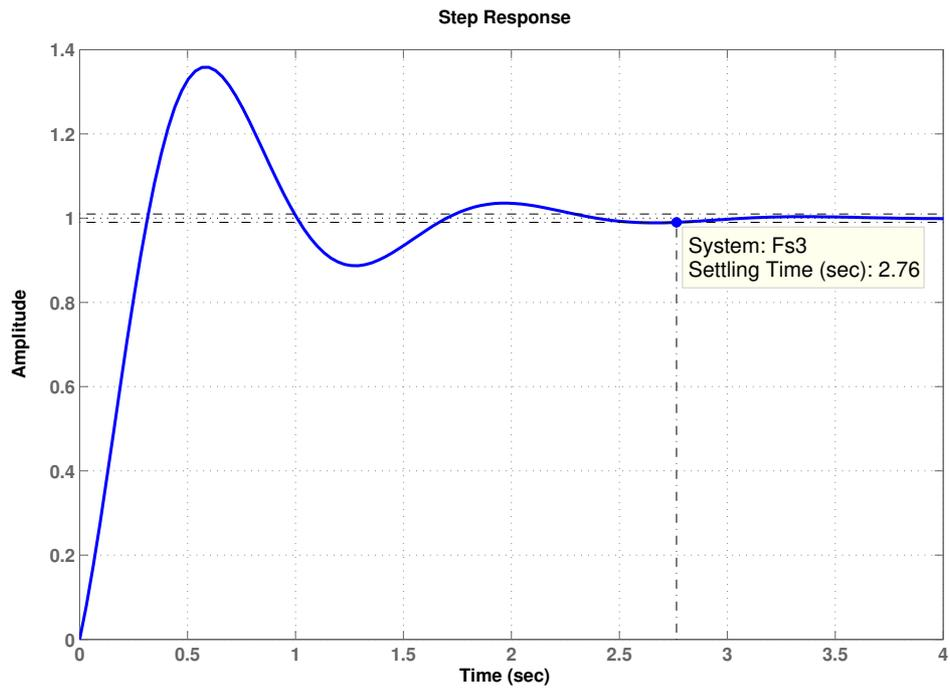
Figura 12: Risposta allo scalino per il sistema a ciclo chiuso con il regolatore scelto.
