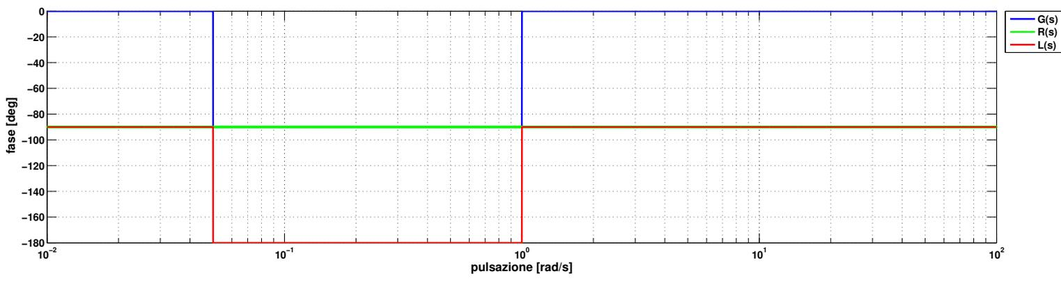
Figura 2: Diagrammi asintotici di Bode della risposta in frequenza, relativi al primo progetto.
