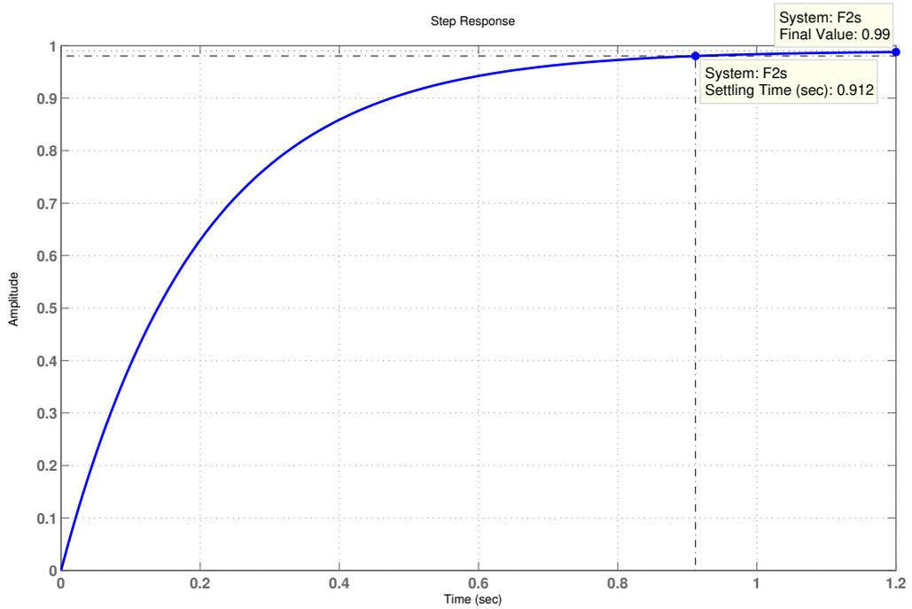
Figura 6: Risposta allo scalino per il sistema a ciclo chiuso nel caso del secondo progetto.
