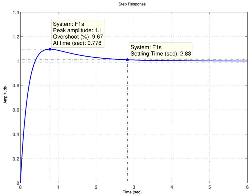
Figura 5: Risposta allo scalino per il sistema a ciclo chiuso nel caso del primo progetto.
