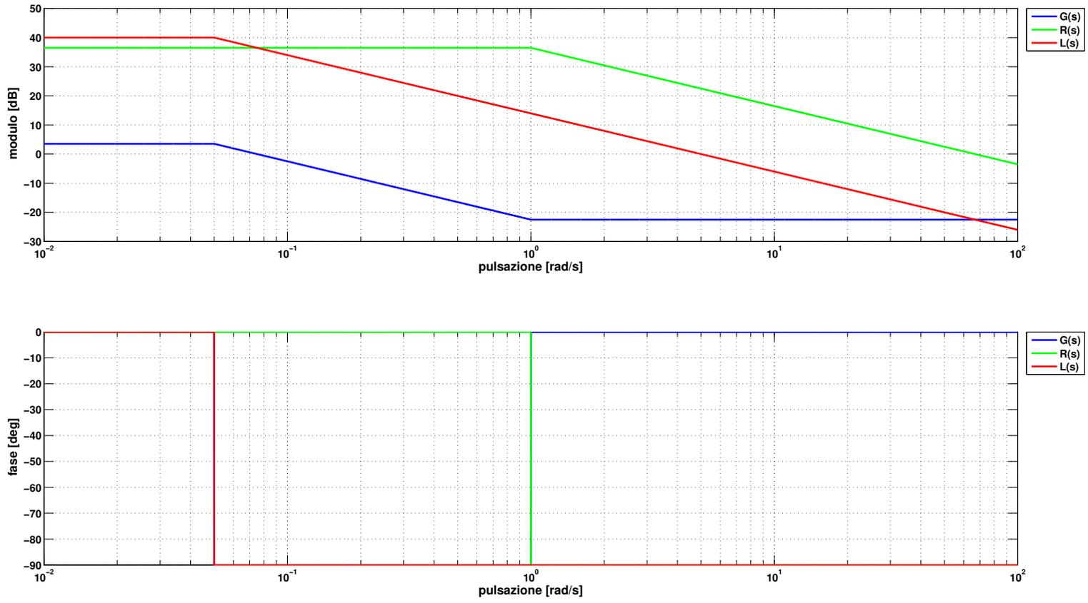
Figura 3: Diagrammi asintotici di Bode della risposta in frequenza, relativi al secondo progetto.
