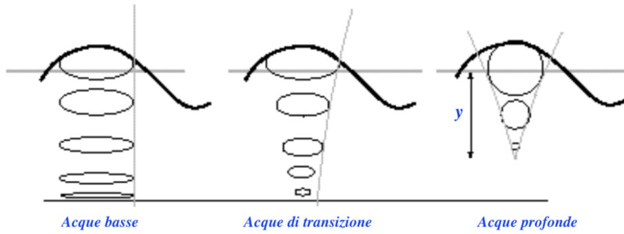
Figura 17.5: In figura sono rappresentate le traiettorie al variare della profondità. Il valore di y = \frac{\lambda}{2}
