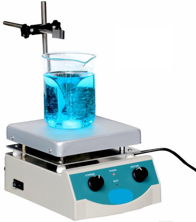
Figura 13.2: Agitatore magnetico. Si osservi che per le condizioni di no-slip \vec{u} = 0 sulle pareti del contenitore; inoltre nella superficie libera (interfaccia aria-acqua) \vec{u} \cdot \vec{n} = 0
