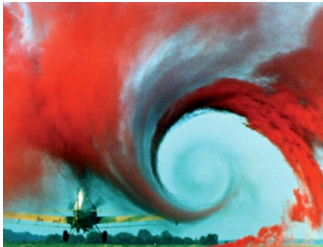
Figura 7.1: Vorticità generata dall'ala di un veivolo.
