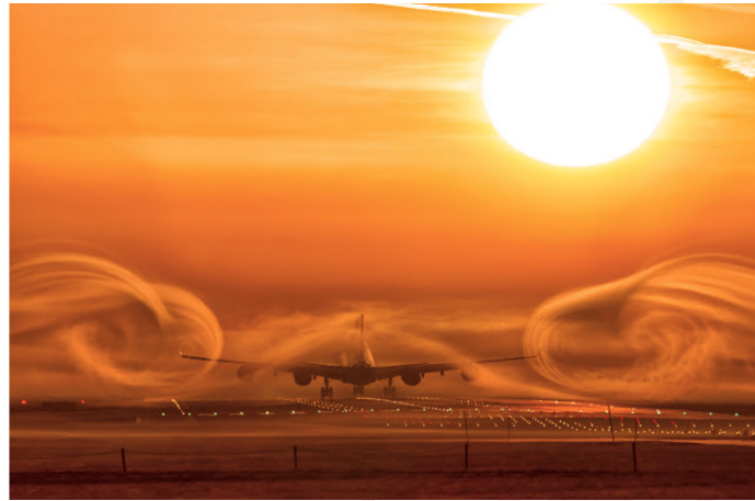
Figura 7.6: Vortici generati da un aereo in fase di atterraggio.
