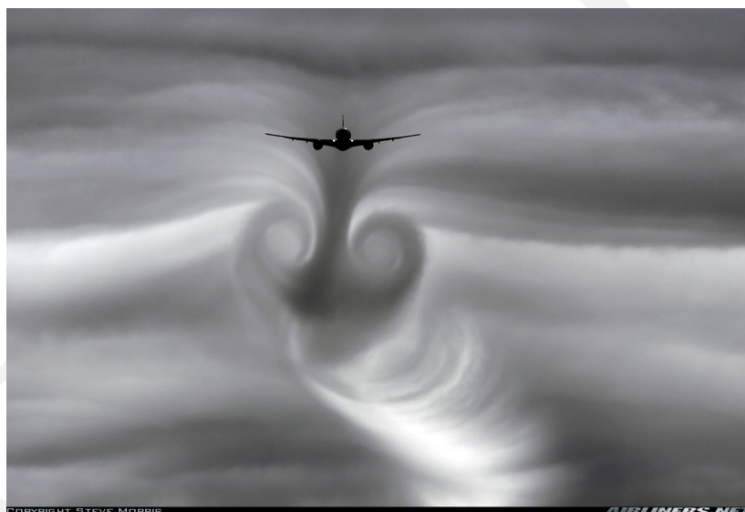
Figura 16.1: Tip vortex, chiamato anche vortice di Berenice, generato dalla estremità delle ali di un aereo
