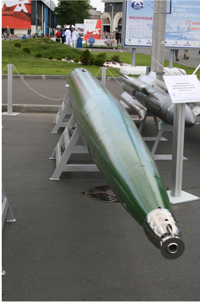
Figura 8.12: Shkval siluro di produzione russa a supercavitazione
