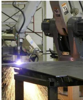
Un gas viene soffiato ad alta pressione da un ugello, contemporaneamente attraverso questo gas si instaura un arco elettrico tra un elettrodo e la superficie da tagliare, che trasforma il gas in plasma. Il plasma trasferisce calore al materiale metallico fino a portarlo alla temperatura di fusione e rompere così la continuità del metallo.
